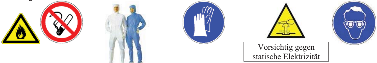
Keine Feuerquelle neben der Installationsstelle
