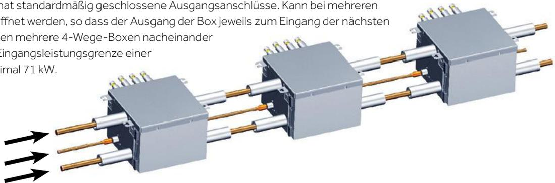
**FLEXIBLE INSTALLATION** - Möglichkeit, die Ausrichtung der Serie umzukehren, um die Anschlüsse der Innengeräte rechts oder links oder abwechselnd zur Hauptleitung zu haben.
