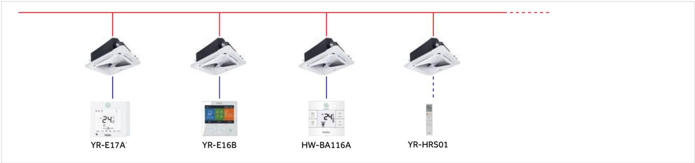
Beispiel für Gruppensteuerung (nur für Kabelfernbedienungen - max. 16 Inneneinheiten mit einer einzigen Fernbedienung)
