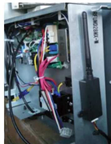
Funktadapter für die Inneneinheit, die an die jeweilige elektronische Platine angeschlossen werden soll.
