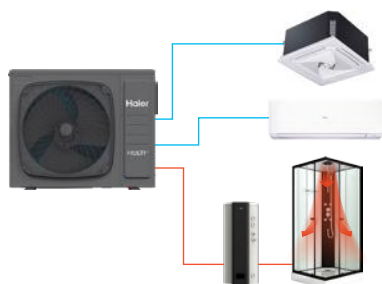
Szenario 5: Häusliches Warmwasser + AC Kühlung
