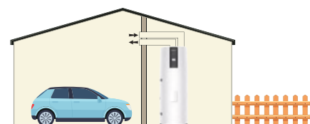
Installation mit 2 Kanälen in einem unbeheizten Raum >15m 2
