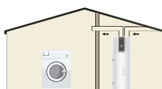
Instalação com 2 condutas para o exterior
