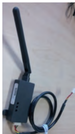
Funkadapter für die Inneneinheit, die an die jeweilige elektronische Platine angeschlossen werden soll.
